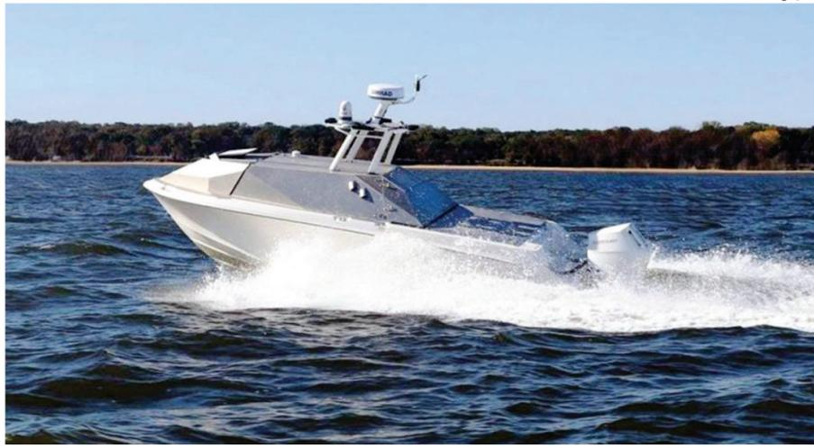
Drone aquático Textron TSUNAMI, embarcação marítima não tripulada, projetada para missões de defesa, vigilância e logística em ambientes marítimos
